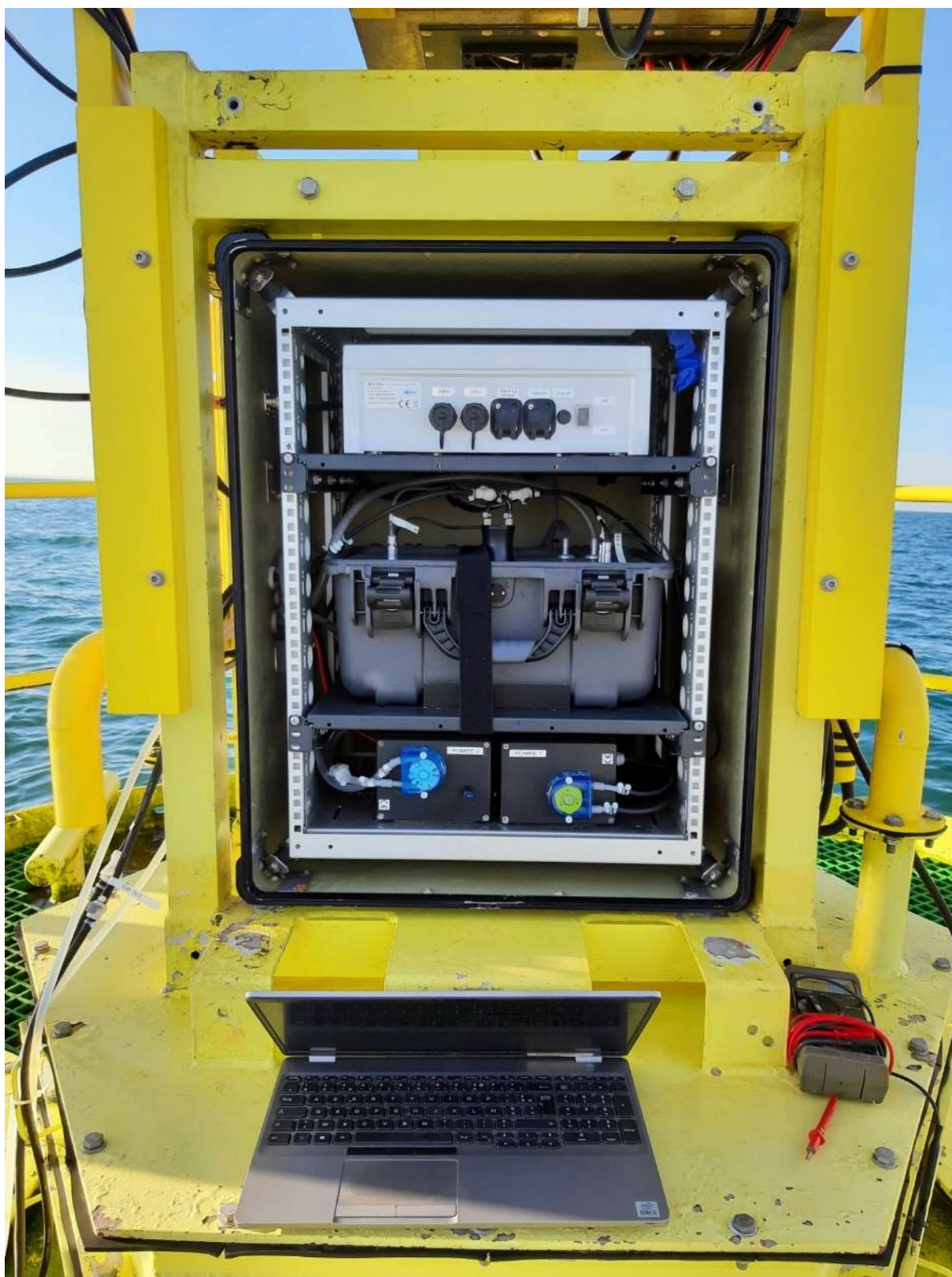
Figure. 24. Intégration du LABSTAF dans un caisson étanche avec pilotage et une transmission de données assurés par un PC embarqué.
