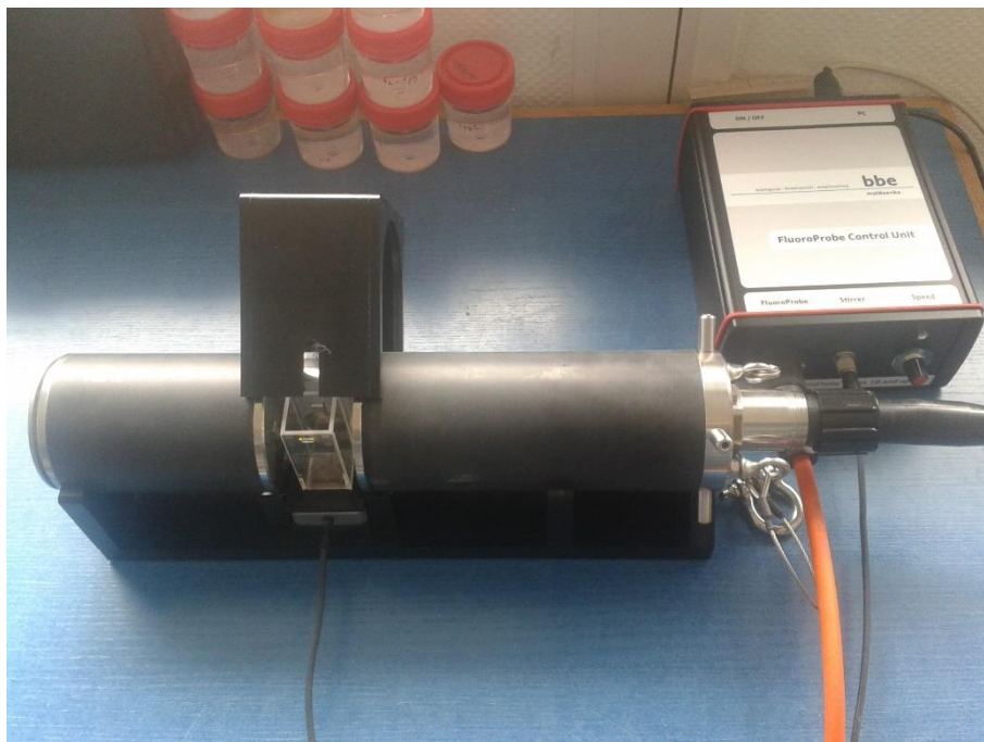
Figure 1: Photo du FluoroProbe sur la station de travail avec sa cuve en quartz de 25 mL.
