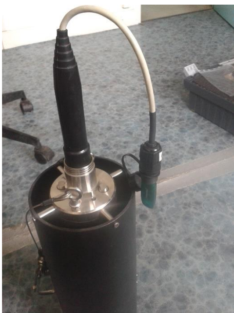
Figure D6 : Récupération des données avec le système plug + USB.
