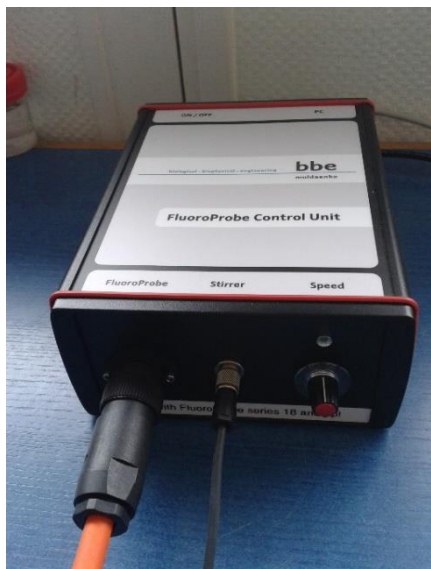
Figure C1 : Unité de contrôle de la « workstation 25 »
