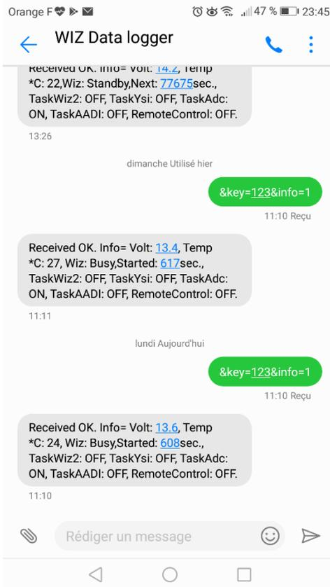
Figure 10 : Impression d'écran depuis un téléphone portable montrant une commande sms envoyée au WIZ pour obtenir des informations sur l'état du WIZ (en vert) et la réponse reçue envoyée par le data logger (en gris). On y apprend entre autre que le WIZ est en analyse (« Busy »), que cette analyse a commencé il y a 608 secondes et que le voltage est de 13,6 V.
